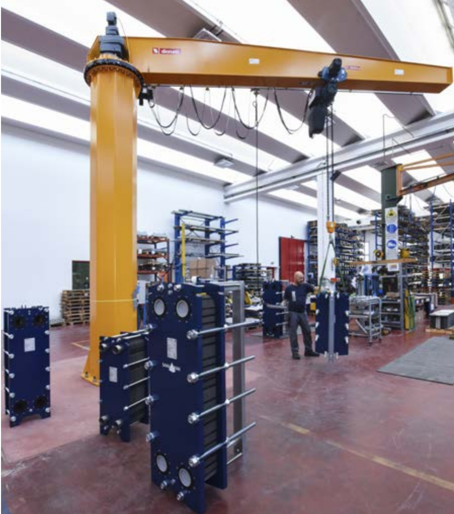
Nuove attrezzature per la movimentazione degli scambiatori
